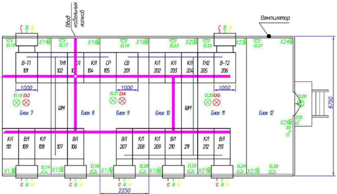
Рисунок 34. План расположения РУ из шкафов КМ-1КФ с ОПУ в КРУ-БМ из 12 блоков
