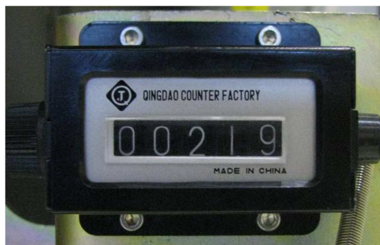
Рисунок 8 Механический счетчик автоматического выключателя
